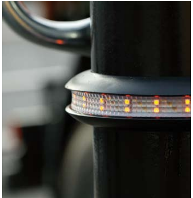
Warnleuchte an der Abstützung
