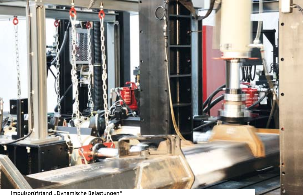
Impulsprüfstand „Dynamische Belastungen“
