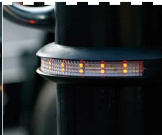
Warnleuchte an der Abstützung
