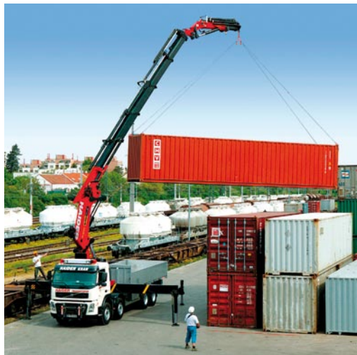
Kran mit Dual-Power-System
