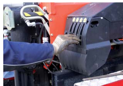
Abstützung weiter anheben
