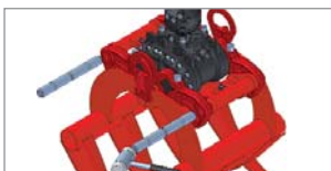
Verbindungsbolzen wieder einschlagen und arretieren.
