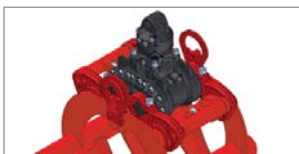
Halteklauen über Wechselgarnitur positionieren und hydr. schließen.
