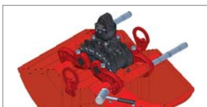
Wechselhilfen anbringen, Arretierung lösen und Verbindungsbolzen austreiben.
