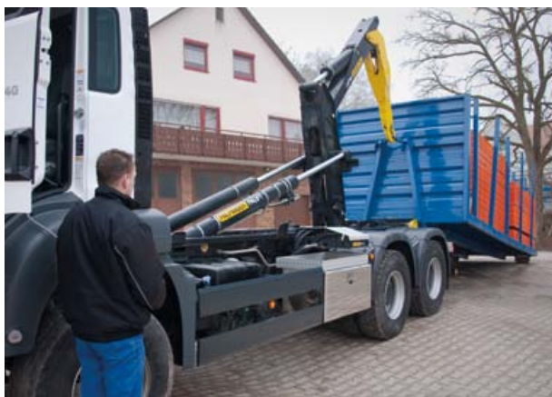
Aufnahme eines Rungencontainers mit Schalungen
